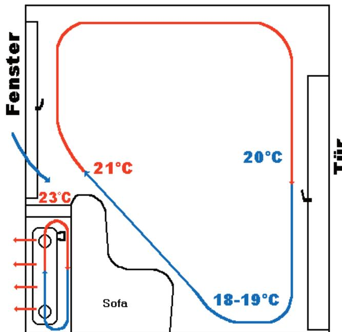
Die Luftströmung (Wärmewalze) wird gestört von:
