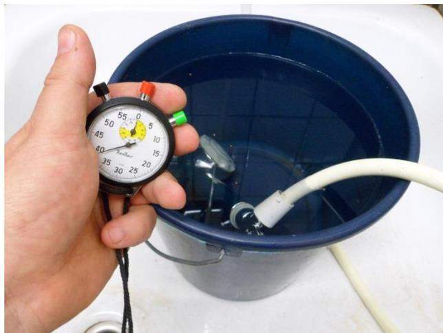
Um den Wasserdurchfluss bei einer Dusche zu messen, braucht man einen Eimer mit einer bekannten Füllmenge. Mit der voll aufgedrehten Dusche wird der Eimer gefüllt und die Zeit gestoppt.
