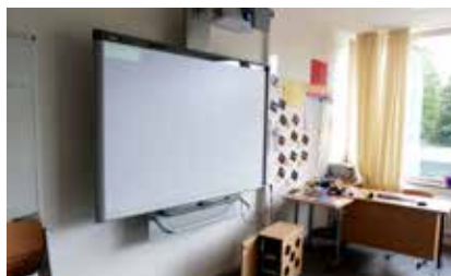
Interaktives Whiteboard ist vor leerem Klassenraum im Betrieb und erzeugt bis zu 350 W Wärmeleistung.
