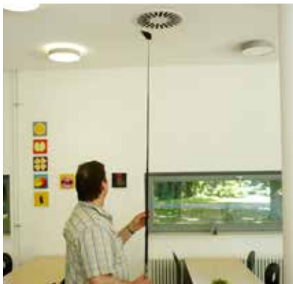
Prüfung der Luftströmung mit Feder.
