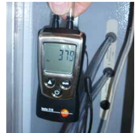
Druckmessung zur Volumstromberechnung an der RLT.
