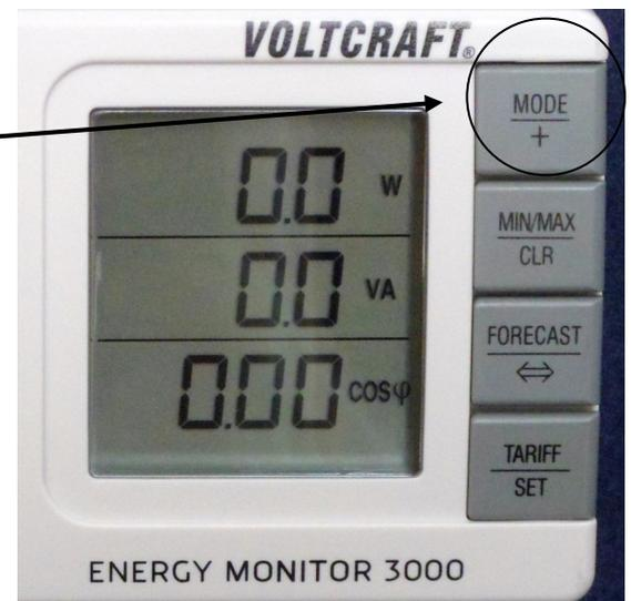
An das Energieverbrauchsmessgerät dürfen nur Verbraucher mit einer Leistung von maximal 3000 Watt (13 Ampere) angeschlossen werden!
