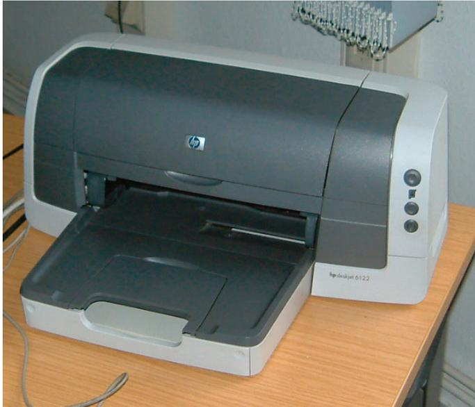
Tintendrucker spritzen die Farbe in feinem Strahl aufs Papier. Hier wird nichts erwärmt. Der Verbrauch hängt vom Gerät und vom Betriebszustand ab:
